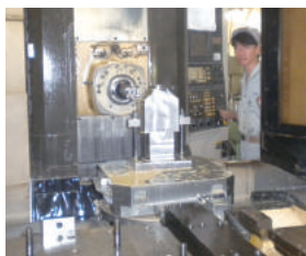
横型マシニングセンターで多面加工作業中の熟練社員
